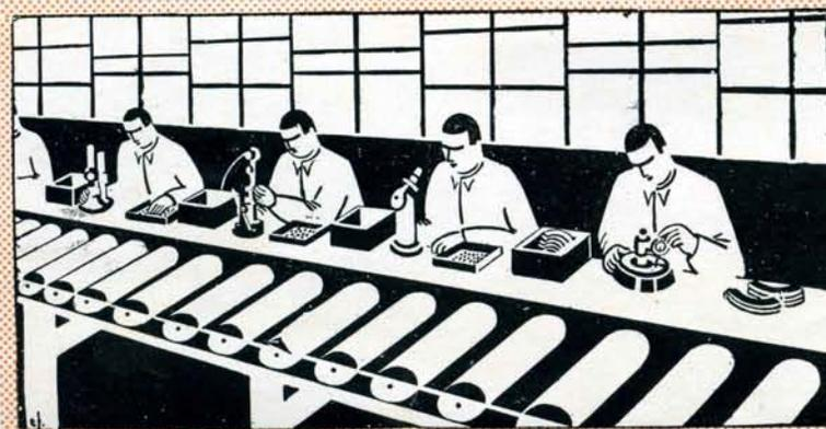
Ebenso streng wie die Rohstoffe prüfen wir auch die Halbfabrikate, Stück für Stück, auf exakte Verarbeitung. Diese Kontrollen werden durch besonders erfahrene, hochbezahlte Spezialisten ausgeführt. Ausgesucht zuverlässige Mikrometer mit silberner, unveränderlicher Skala kommen bei diesen Prüfungen zur Verwendung.
